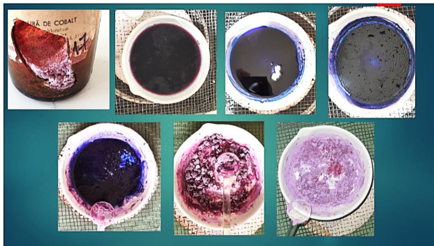
Figura 5. Etape ale deshidratării clorurii de cobalt cristalizate
