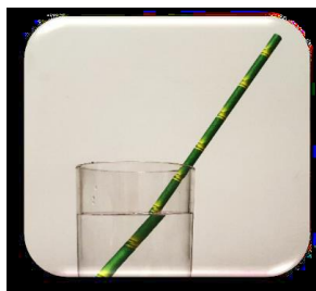
Figura 3. Punerea în evidență a refracției luminii
