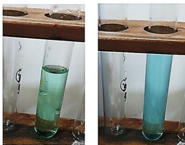
Figura 1. Obținerea complexului [\text{Ni}(\text{NH}_3)_6]\text{Cl}_2
