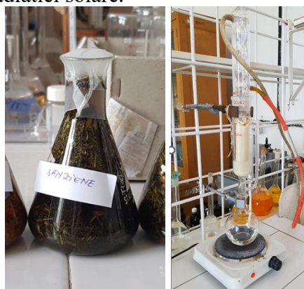
Figura 1. Obținerea extractelor de eco-inhibitori prin macerare și reflux
