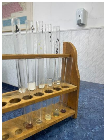
Figura 9. Aspectul substanțelor (aspirină, paracetamol, ibuprofen, necunoscută) înainte și după reacția cu \text{FeCl}_3 .
