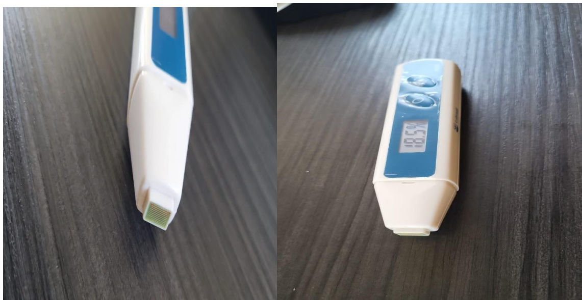
Figura 1. Dispozitiv pentru măsurarea gradului de hidratare a tegumentului (analizator de impedanță bioelectrică)
