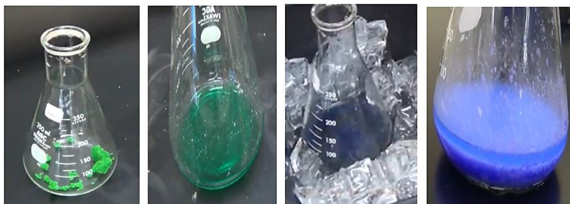
Figura 2. Etapele ale sintezei [\text{Ni}(\text{NH}_3)_6]\text{Cl}_2
