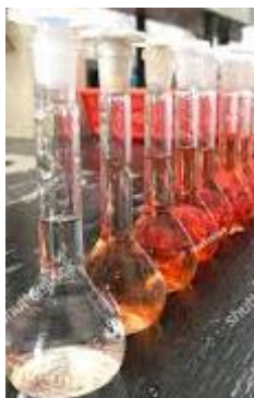
Figura 6. Soluțiile preparate pentru curba de etalonare
