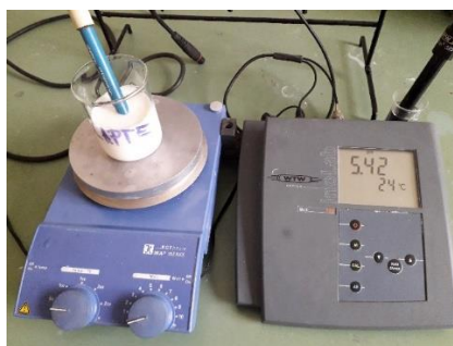
Figura 2 Determinarea valorii pH-ului laptelui cu ajutorul pH-metrului
