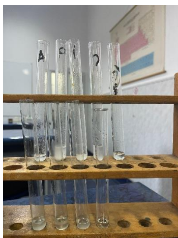
Figura 8. Aspectul substanțelor (aspirină, paracetamol, ibuprofen, necunoscută) înainte și după reacția cu \text{NaHCO}_3 .
