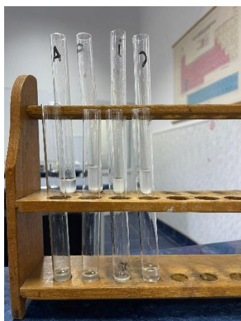
Figura 7. Aspectul substanțelor (aspirină, paracetamol, ibuprofen, necunoscută) înainte și după reacția cu NaOH (jos)
