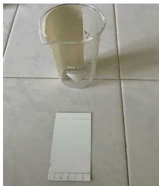
Figura 1. Plăcuță cromatografică de silicagel, marcată cu liniile fronturilor și eluentul în pahar Berzelius.
