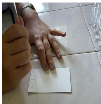
Figura 4. Aplicarea spoturilor pe plăcuța de silicagel, folosind capilare de sticlă.
